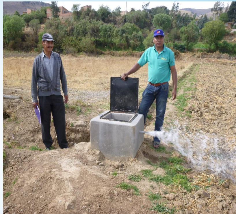
Prueba del Caudal de Agua en los Hidrantes de la Comunidad de Mayu Molino
